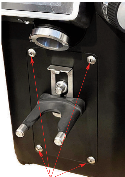
Desatornillar los 4 tornillos del módulo
