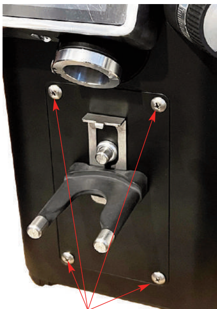
Die 4 Schrauben des Moduls abschrauben
